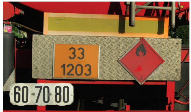
Signalisation d'un poids lourd (code danger et code de la matière transportée)
